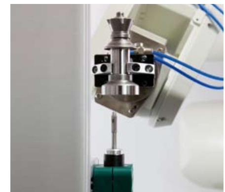
Je nach Messaufgabe und zu messender Geometrie kommen Standardmessmittel oder individuelle Messaufnahmen zum Einsatz. Der Roboter kann entweder das Bauteil zum Messmittel oder das Messmittel zum Bauteil führen.
