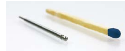
Rotationssymmetrische Lehre für die Medizintechnik, Rundheitstoleranz: 0,002 , Kuppenradius: 0,95 \pm 0,002
