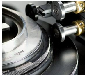
Das Kegelmaß der konischen Zahnflanken ist sehr eng toleriert.
